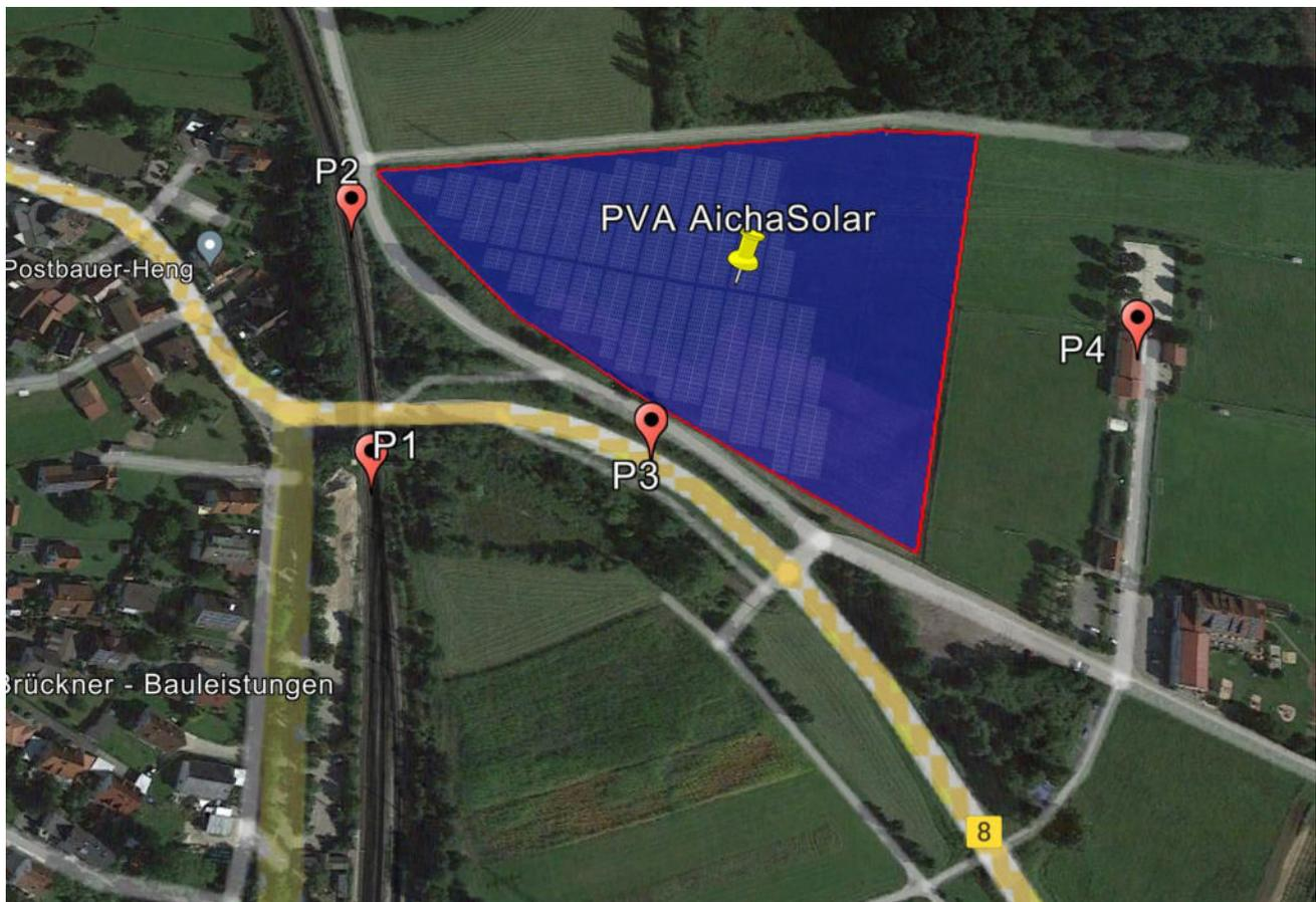
Bild 3.5.1: Exemplarisch gewählte Messpunkte P1 – P4 für die Analyse der Reflexionen (Quelle: Google Earth/SolPEG)
